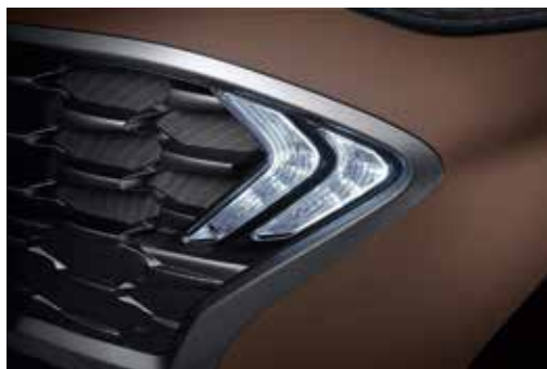
Cụm đèn ban ngày DRL (Daytime Running Light) được thiết kế phá cách dạng boomerang
