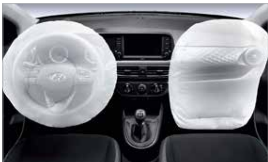
Hệ thống an toàn 2 túi khí
